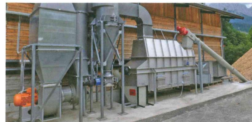
Kompletanlage zur Trocknung von Holzhackschnitzeln (500 kg/h)
