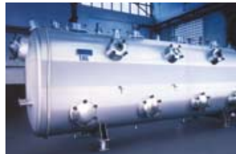
Wirbelschichttrockner zur Herstellung von Hilfsstoffen wie z.B. Milchpulver, Lactose und Zitronensäure.
