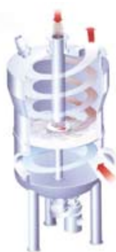
Flugschichttrockner zur Herstellung z.B. von Silymarin
