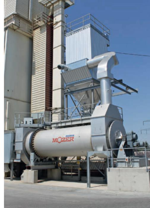
1 Trommelrockner/Kühler für Sande • Dryer drum/cooler for sand
