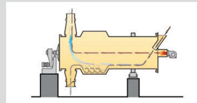
Der Kalkstein durchläuft zuerst die Trocknungszone. Nach der intensiven Trocknung werden die Körnungen in der Trocken-Reinigungszone aneinander gerieben und dadurch die Lehm- oder Tonverschmutzungen vom Stein gelöst. Die getrockneten und zu Staub gewordenen Schmutzanteile werden mit der Abluft einer Staubfilteranlage zugeführt. Das getrocknete und gereinigte Gestein wird aus dem Trockner ausgetragen und kann einer weiteren Aufbereitung zugeführt werden.
