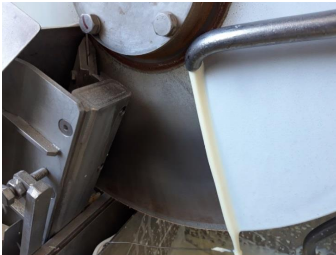
Bild 1 und 2: Trocknung von Milchkonzentrat mit dem CDry 501 lab
