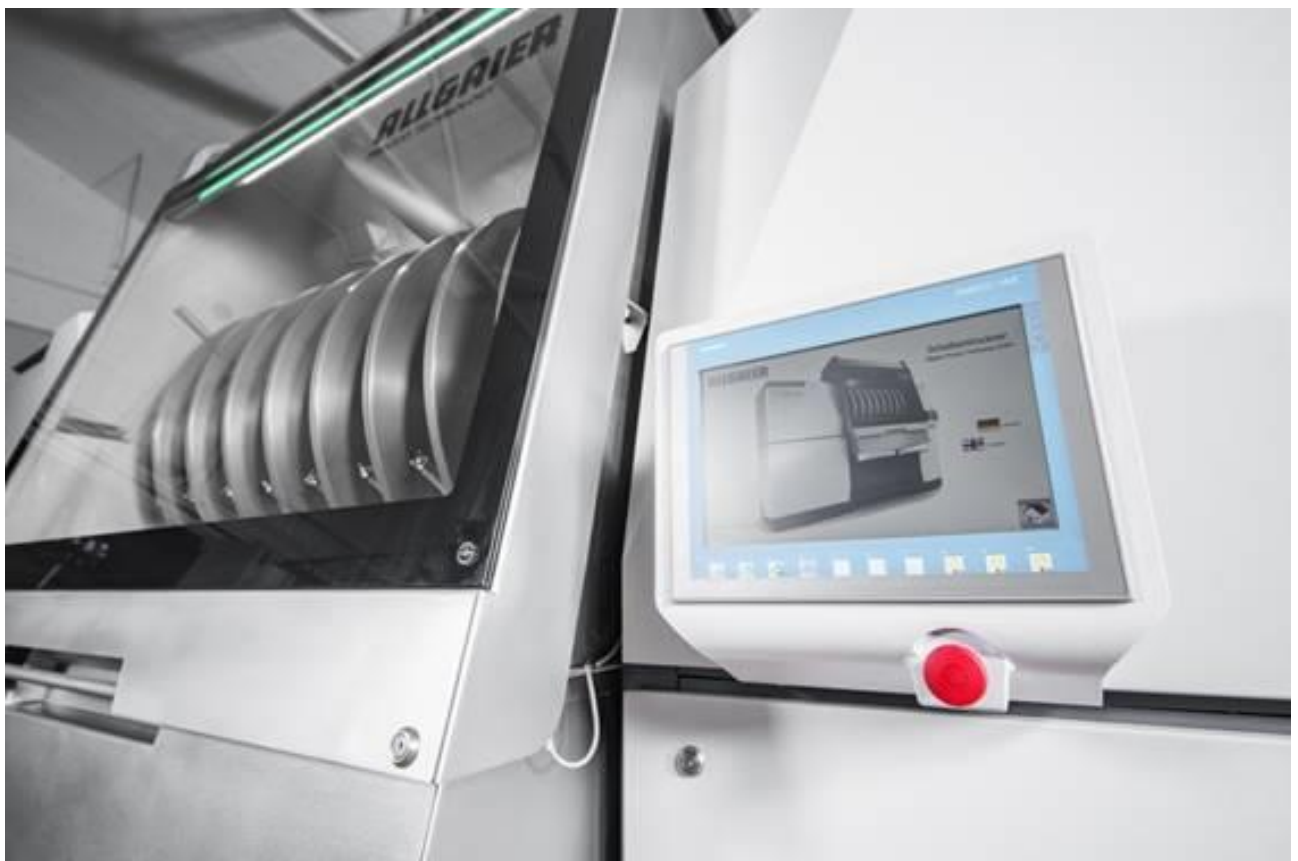
Bild 5: Intelligente Anlagensteuerung über das intuitiv bedienbare Touchpanel zum Abrufen und Ändern der aktuellen Maschinen- und Prozessparameter.
