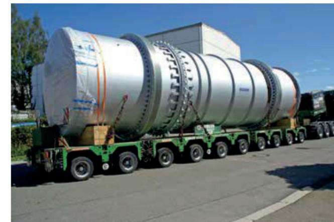
Trocken-Kühltrommel MOZER TK+ für 100 t/h Sand
