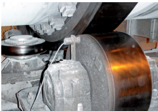
Laufrollenstation eines Kühlers für Titandioxid in Betrieb
