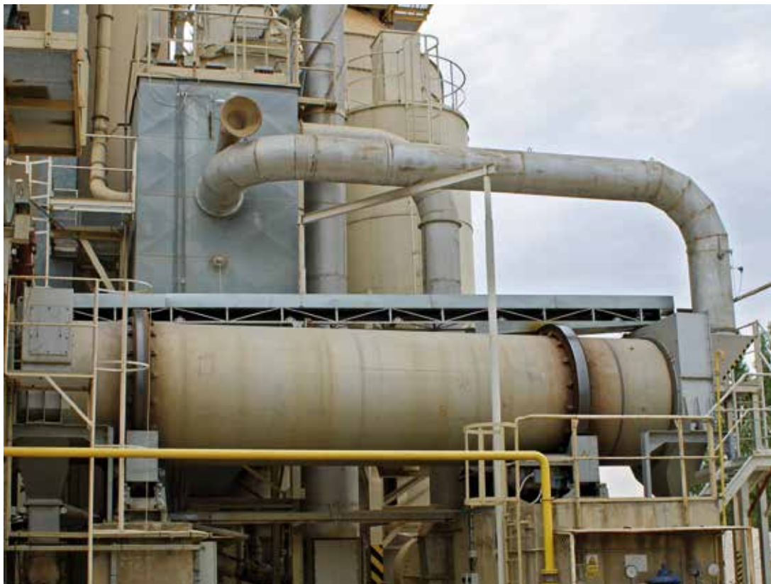
Trocken-Kühltrommel MOZER TK+ für 100 t/h Sand
