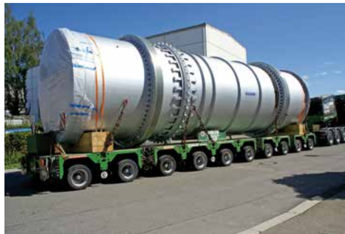
Trocken-Kühltrommel MOZER TK+ für 100 t/h Sand
