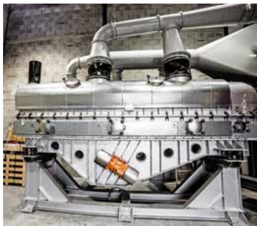
Wirbelschichttrockner als Freischwinger zur Trocknung von Ruß
