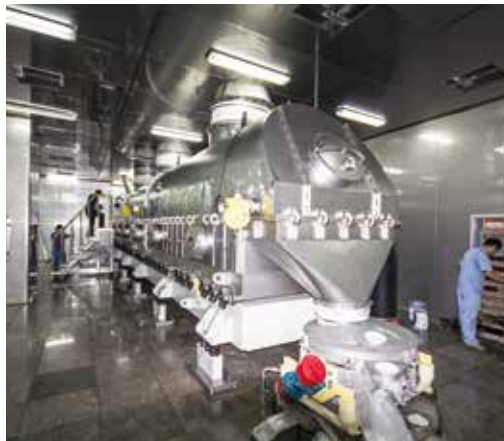
Vibrations-Wirbelschichttrockner im Lebensmittelbereich
