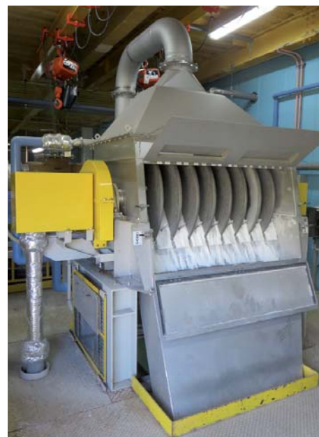
Der Allgaier-Scheibentrockner CD Dryer® in Betrieb. Foto: ALLGAIER Process Technology GmbH
