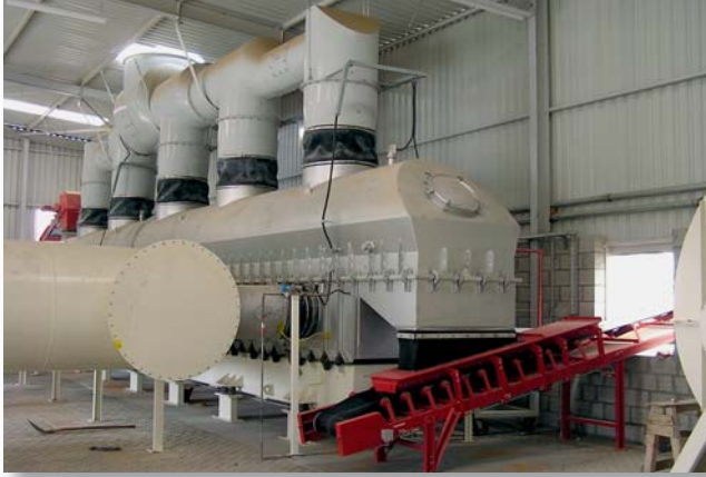
Figure 7: Fluidized-bed dryer/cooler for minerals Bild 7: Fließbettrockner/-kühler für Mineralien
