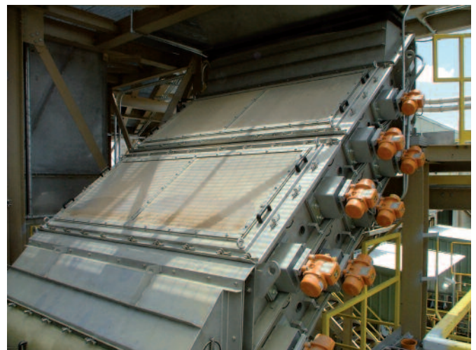
ND 2530 mit Plexiglashauben – Siebung von Holzspänen
