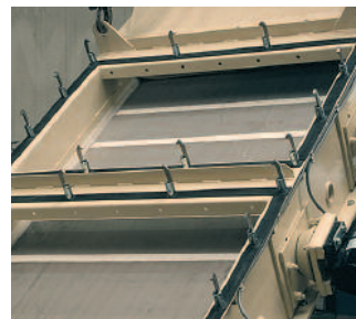
Siebgewebe mit Kunststoffschleißschutz im Bereich der Schlagleisten
