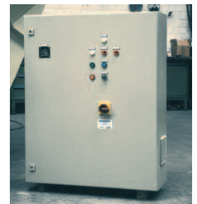
Schaltschrank mit Frequenzumformer und Intervallreinigung
