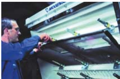
Technikum zur Durchführung von Siebversuchen
