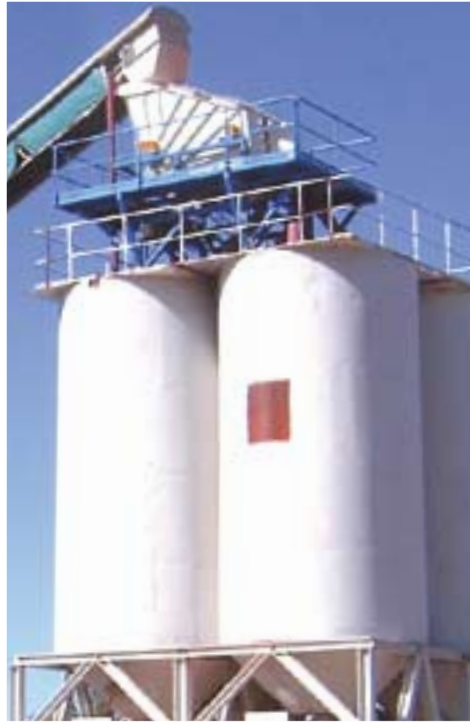
Siebanlage in der Steine-/Erdenindustrie
