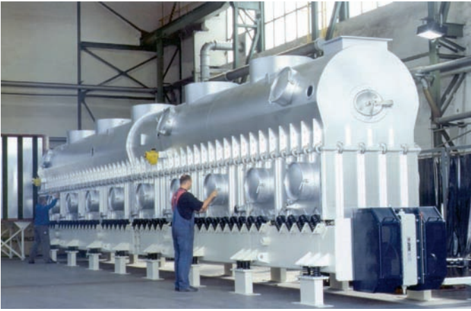
Vibrations-Wirbelschichttrockner zur Trocknung von Sand, Kalkstein und Marmor
