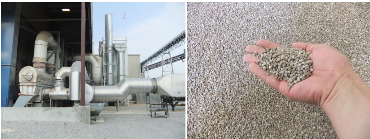
Abb. 4a und 4b: Fließbett-Trocknungsanlage für Gips-Granulat und hergestelltes Produkt
