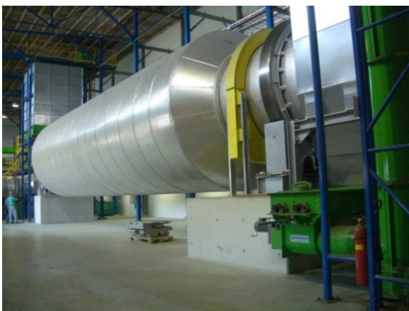
Abb. 6: Trommeltrockner zur Trocknung von Papierfangstoffen im sauerstoffreduzierten Heißgaskreislauf
