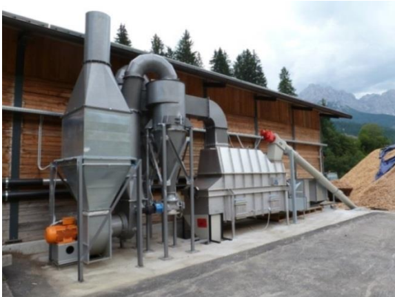
Abb. 5: Wälzbett-Trockner zur Trocknung von Hackschnitzeln für eine Holz-Vergaseranlage
