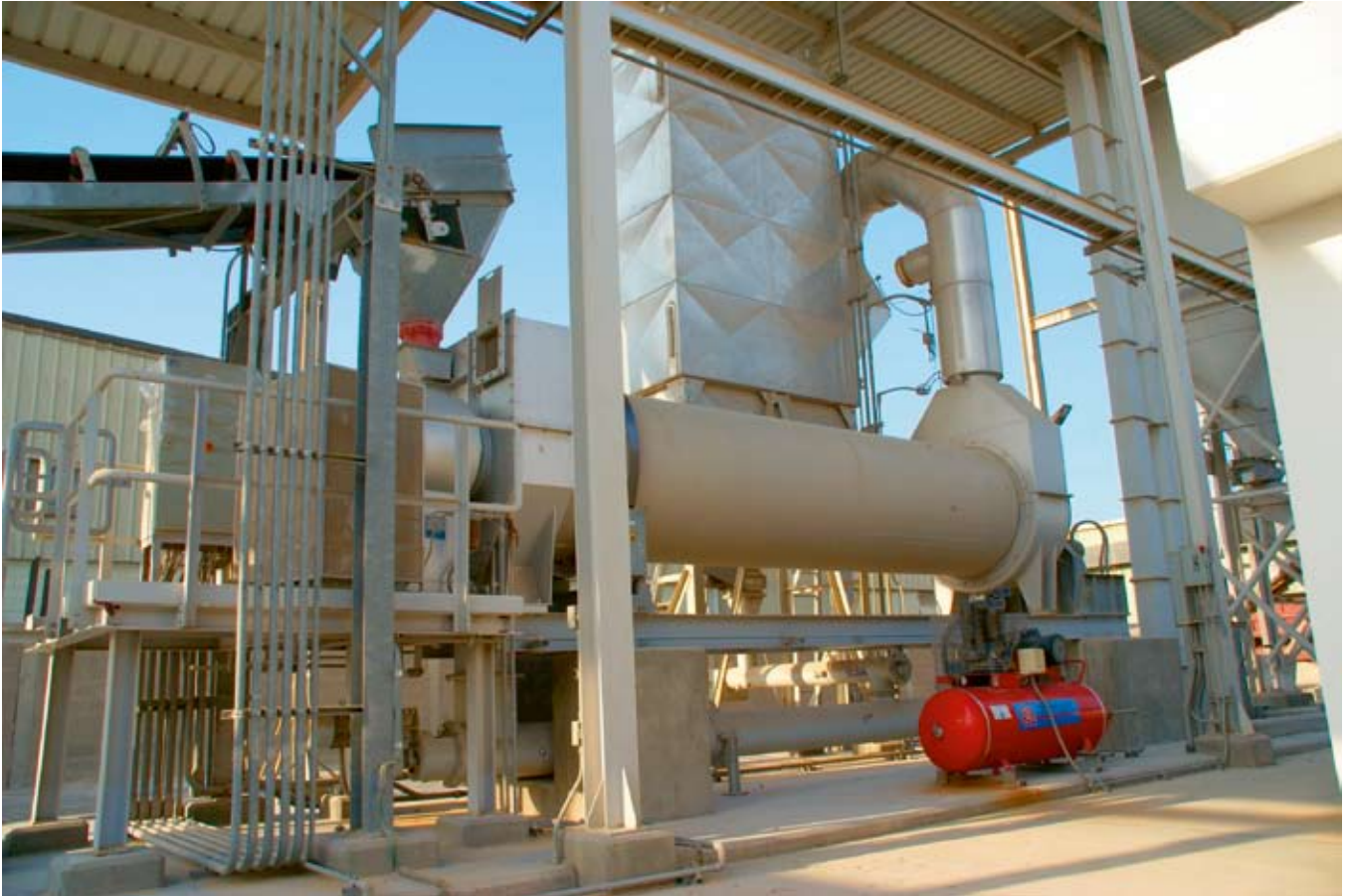
Typische Trommelrockner-Anlage zur Trocknung und Kühlung von Quarzsand • Typical drum dryer for drying and cooling silica sand
