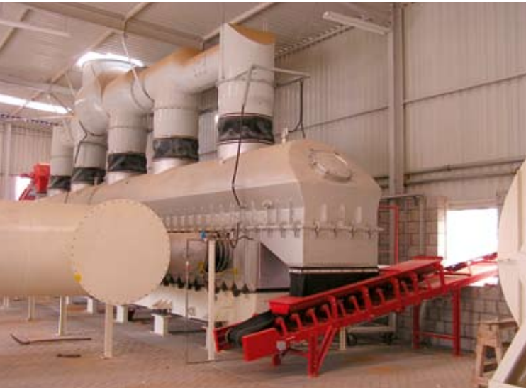
6 Fließbettrockner/Kühler für Mineralien Fluidized bed dryer/cooler for minerals
