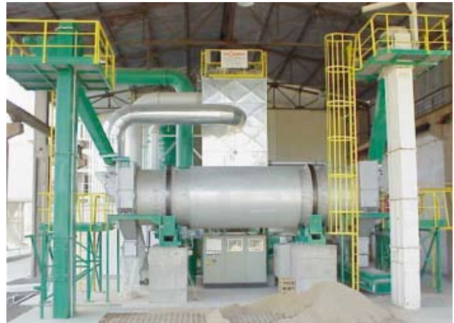
4 Trocken-Kühltrommel System MOZER® „TK_plus“ mit beidseitiger Zuführung des Feuchtsandes MOZER® „TK_plus“ system drying-cooling drum with feed of the wet sand on both sides
