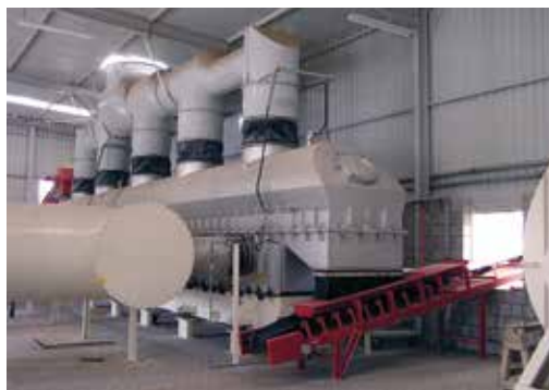
Sécheurs à lit fluidisé à vibrations pour le séchage des matières premières minérales
