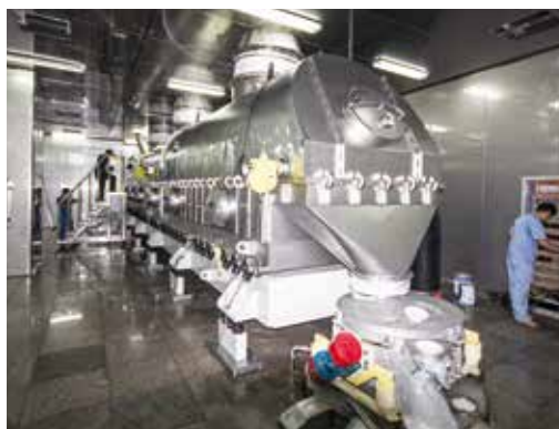
Sécheurs à lit fluidisé à vibrations dans le secteur agroalimentaire
