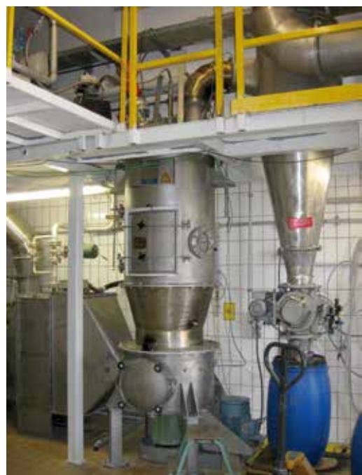
Sécheurs à couche volante FL-T au centre technique Allgaier
