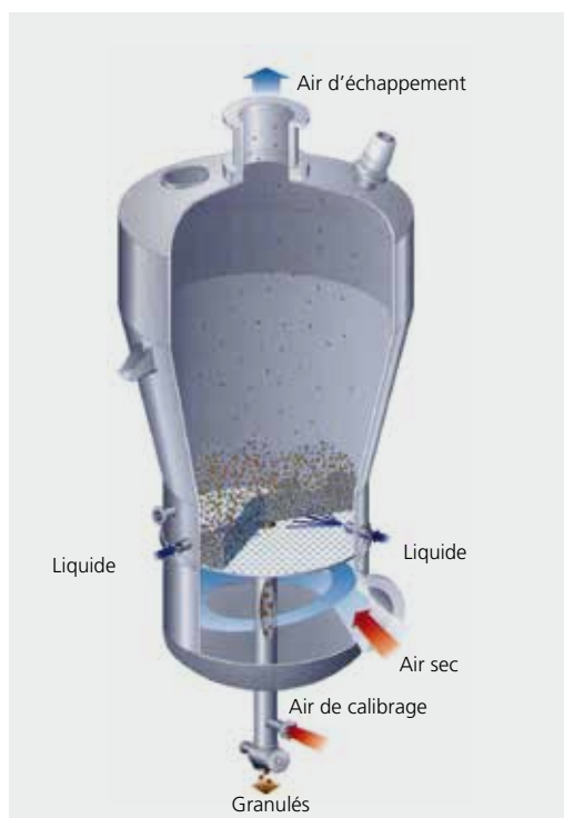
Sécheur à granulation continue WS-GT avec évacuation classifiée des produits
