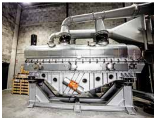
Sécheurs à lit fluidisé comme hauts-parleurs électromagnétiques pour le séchage de la suie
