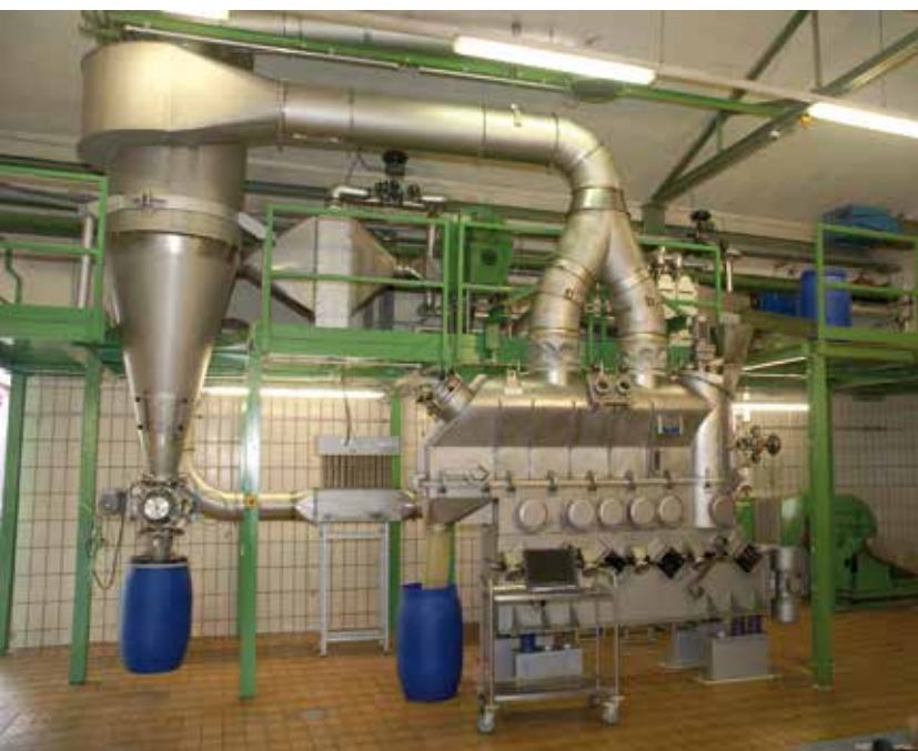
Sécheurs à lit fluidisé et/ou fluidifiés WS-V-T-K du centre technique
