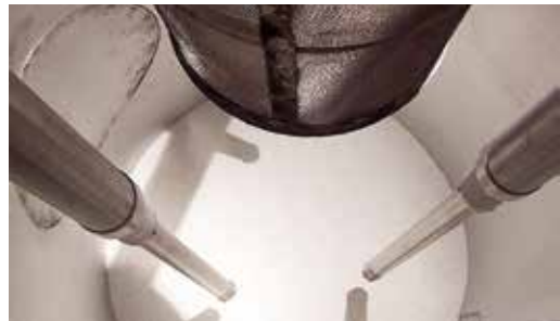
Sécheur de suspensions et de pâtes WS-IB-T pour la fabrication de poudres issues de liquides et de pâtes
