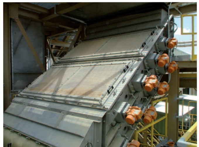
ND 2530 avec capots en plexiglas – Criblage de copeaux de bois
