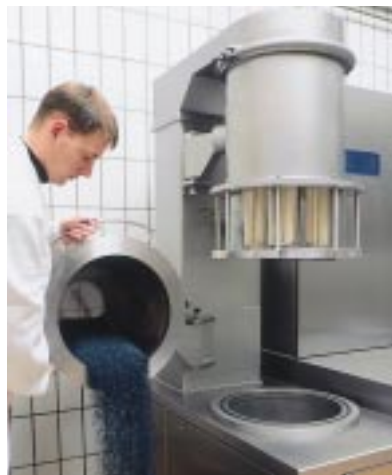
Des conteneurs d'une capacité de 25, 30 et 35 l permettent de traiter de manière optimale des charges de 5 à 15 l.
