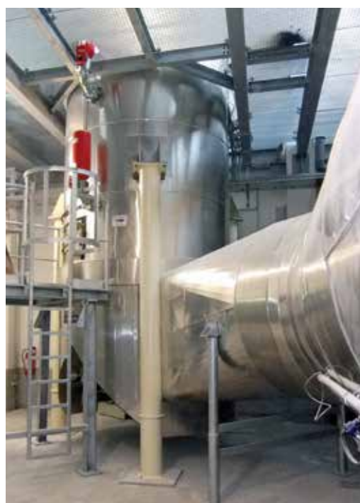
Нижняя часть сушилки с впуском воздуха для сушки
