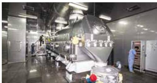
Вибрационная сушилка с псевдоожиженным слоем в производстве пищевых продуктов
