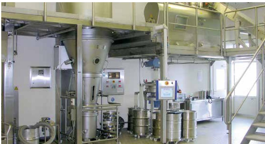
Фармацевтическое оборудование для сушки и покрытия
