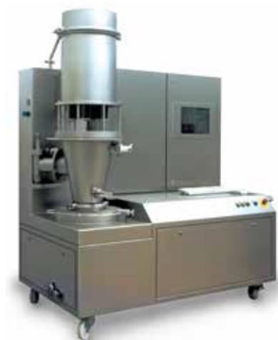
Лабораторная сушилка с псевдооживленным слоем WS-CT-L
