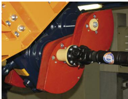
Направленный возбудитель с демонтированным защитным кожухом
