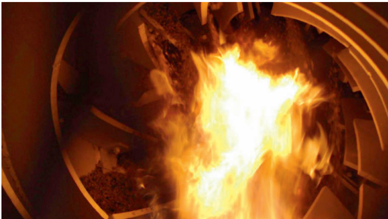
Внутреннее пространство барабанной сушилки с пламенем внутри
