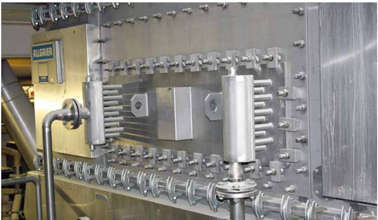
安装有管束式间接加热器的流化床干燥机
