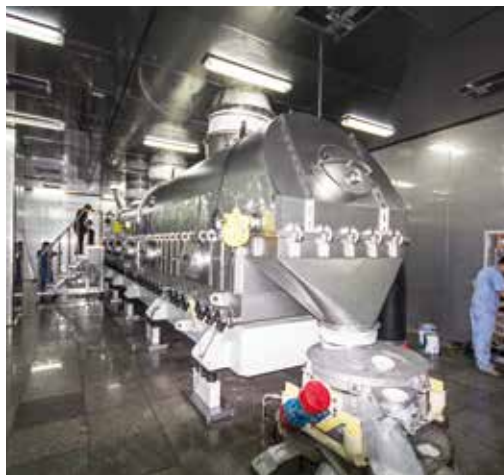
食品领域的振动式流化床干燥机
