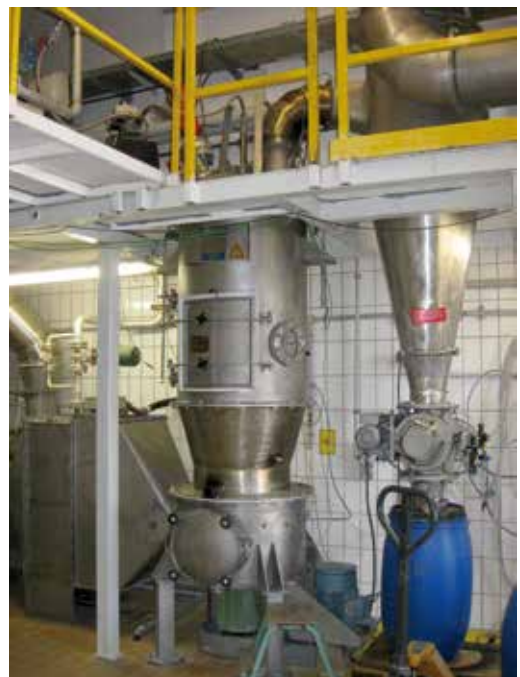
Allgaier 技术中心中的闪干式干燥机 FL-T
